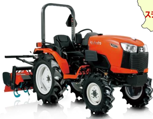
21馬力トラクタ + 標準ロータリ 1.2m
