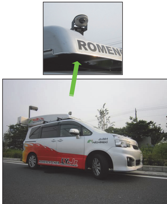
写真-2.1.1 路面性状測定車の外観
