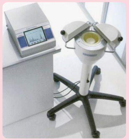
測定器「ガンマ線スペクトロメーター」(重量約80kg)セシウム134、137の合算値を測定できる。約10ベクレル/kg(20分)まで測定可能。4月から給食センターに配備される予定です。
